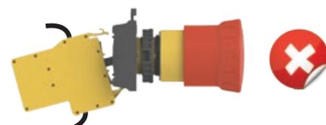
Bloco **NÃO** montado corretamente na flange.
